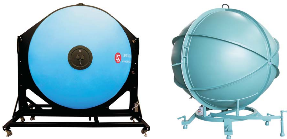
Figura: Esfera integradora con moldura A versus esfera integradora tradicional
