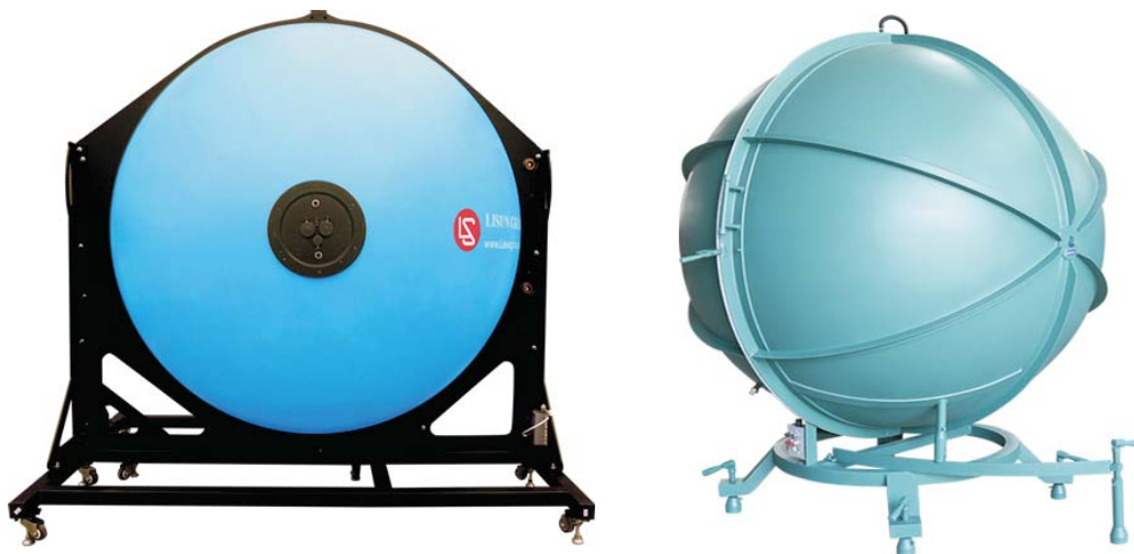
Рисунок: Одноразовая интегрирующая сфера VS традиционная интегрирующая сфера
