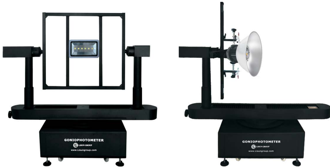
LSG-1890B 采用日本三菱伺服电机和德国解码器
